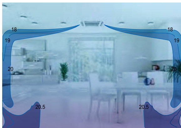
Dystrybucja powietrza w trybie chłodzenia, temperatura w pomieszczeniu 27°C
