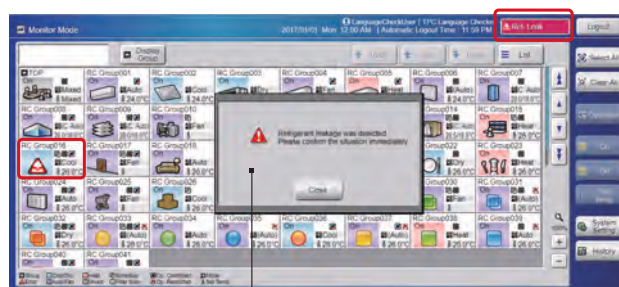
Wyskakujące okienko z informacją o wycieku
